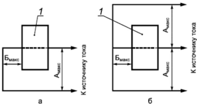
1 - испытуемый трансформатор;  $A_{\max}$  - расстояние между осями проводников соседних фаз в месте установки трансформатора в эксплуатации;  $B_{\max}$  - расстояние в свету от трансформатора до места ближайшего изгиба проводника, служащего в эксплуатации первичной обмоткой трансформатора
